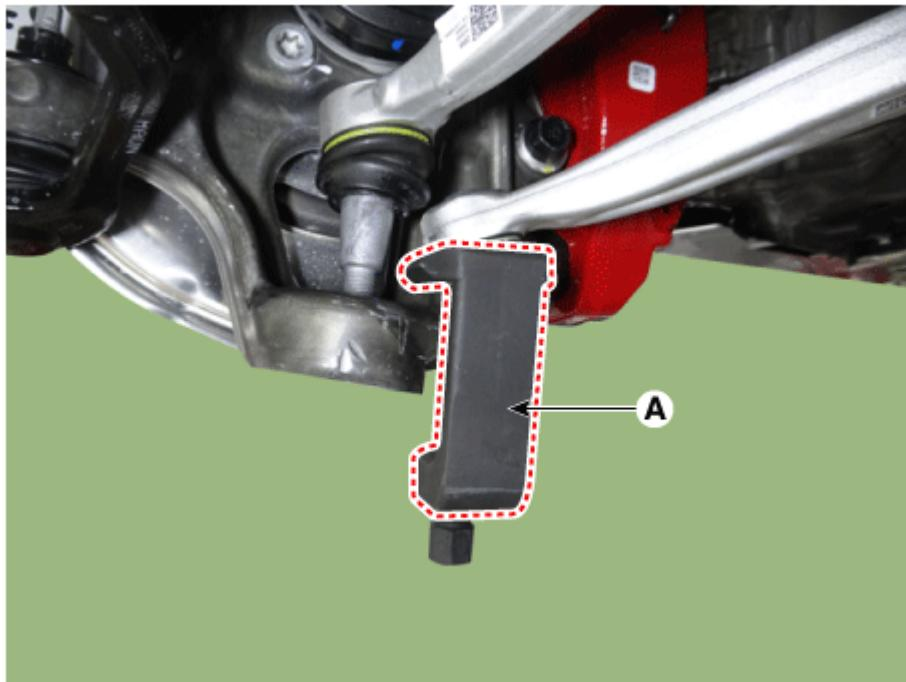
8. Remove the tie rod end nut.
